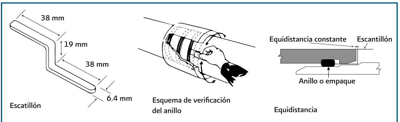
Figura 2.8 Verificación de los anillos de hule en la junta
