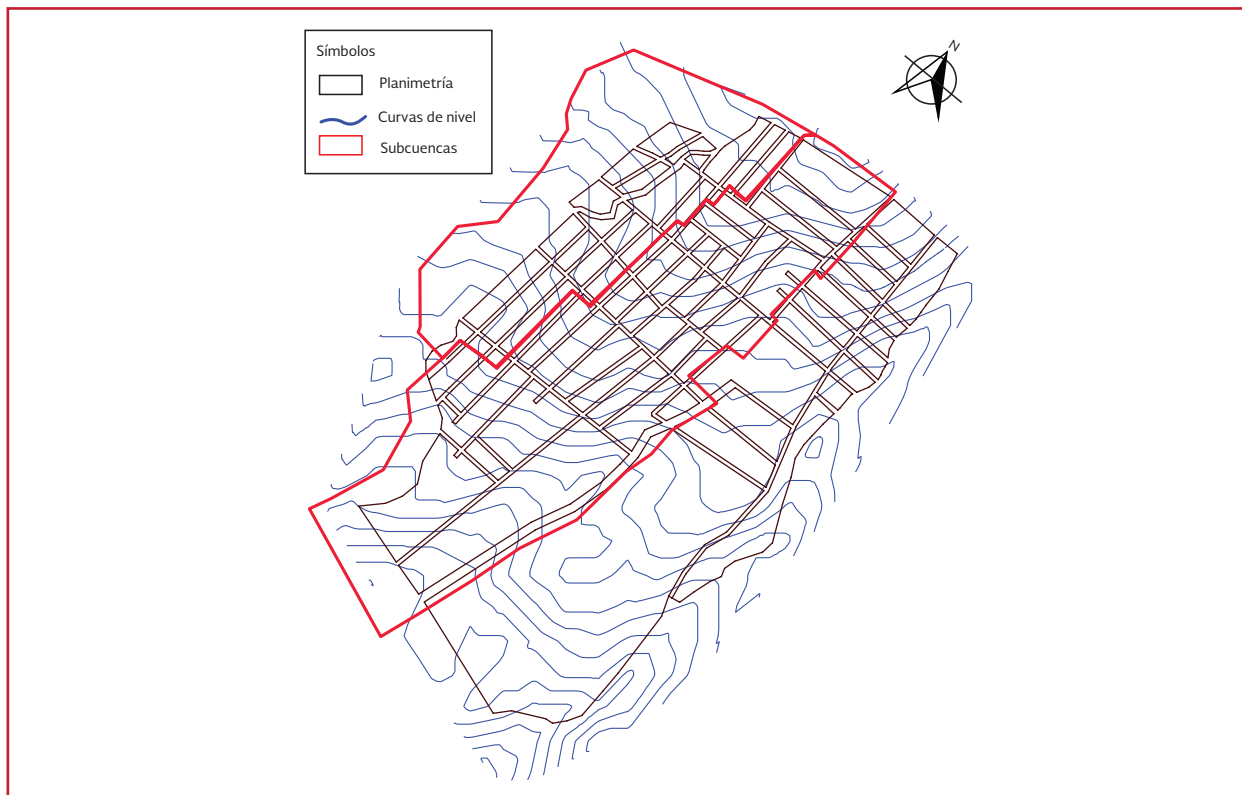
Ilustración 2.10 Definición de subcuencas considerando la lotificación
